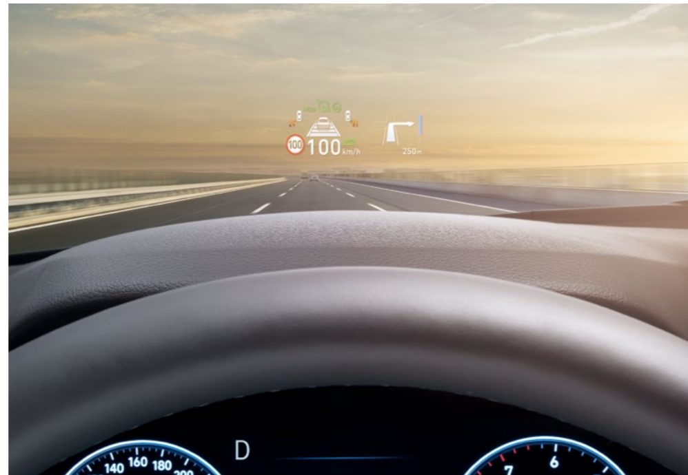
Проекция показаний приборов на лобовом стекле
