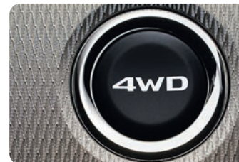
Управление режимами полного привода кнопкой
